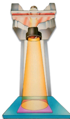
Uma fonte de luz é focalizada é projetada por meio de uma coluna em movimento de óleo.
